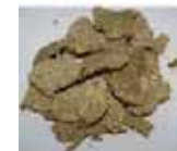
Zerkleinerte Spanplatten d_p \approx 30 \text{ mm} , w \approx 8\%
