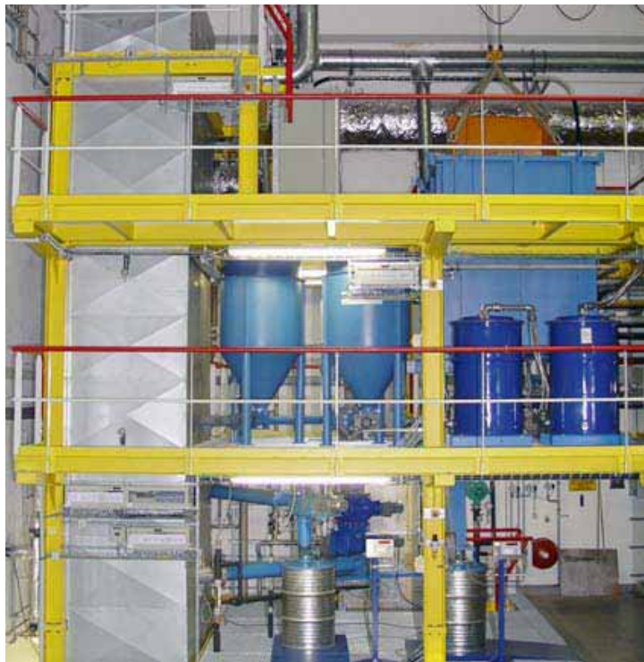
Zirkulierende Wirbelschicht als Vergaser für Biomasse
