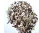
Hackschnitzel (Kiefer) mit hohem Rindenanteil d_p \approx 10 \text{ mm} , w \approx 34\%
